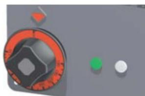
Zkontrolujte, zda je vypouštěcí kohout uvnitř otvoru uzavřen (horizontální poloha).
